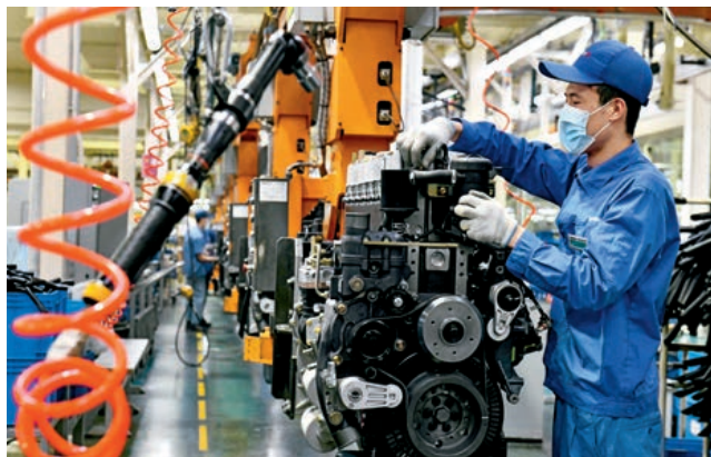
在山东潍坊的潍柴集团总装车间,工人在流水线上装配发动机。摄影/新华社记者 郭绪雷
