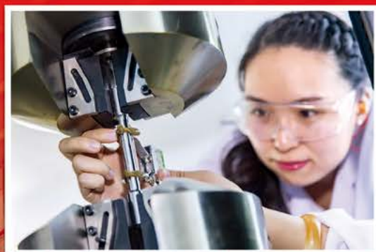
工程院科技工作者开展金属材料力学性能检测
